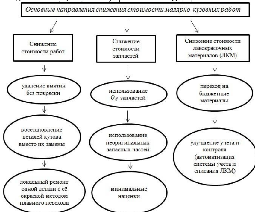
Рис. 2. Направления по снижению стоимости малярно-кузовных работ
