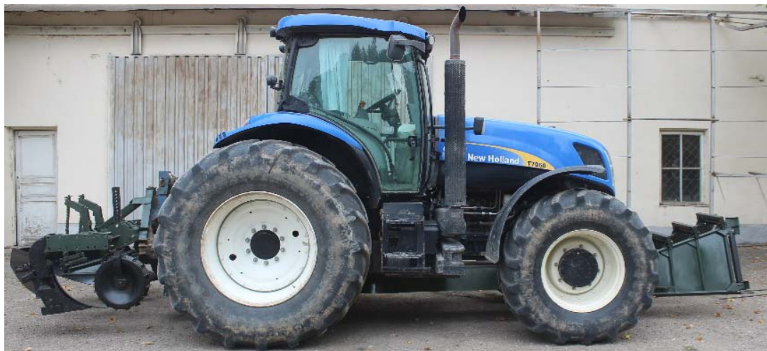
3-расм. Анор тупларини кўмадиган машинанинг тажриба нусхаси
