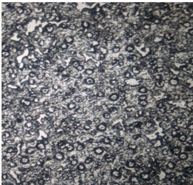
3-rasm. Yuqori mustahkamlikka ega bo'lgan cho'yan "BЧ50" markasini mikro tuzilishi.
