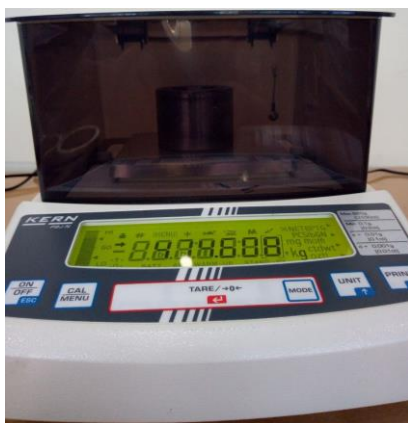
2-rasm. Mavjud va tavsiya etilgan sirpanish podshipnigini tashkil etuvchi ichki va tashqi silindrlarini tortish jarayoni
