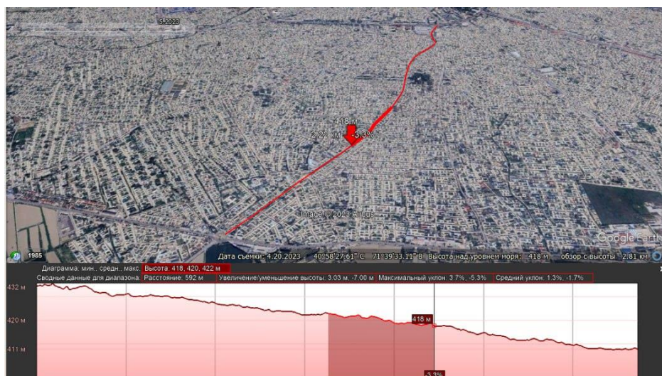
3-rasm. Namangan shaxar Ma'rifat MFY Qo'qon ko'chasini geometrik o'lchamlarini GAT texnologiyalari orqali aniqlash.
