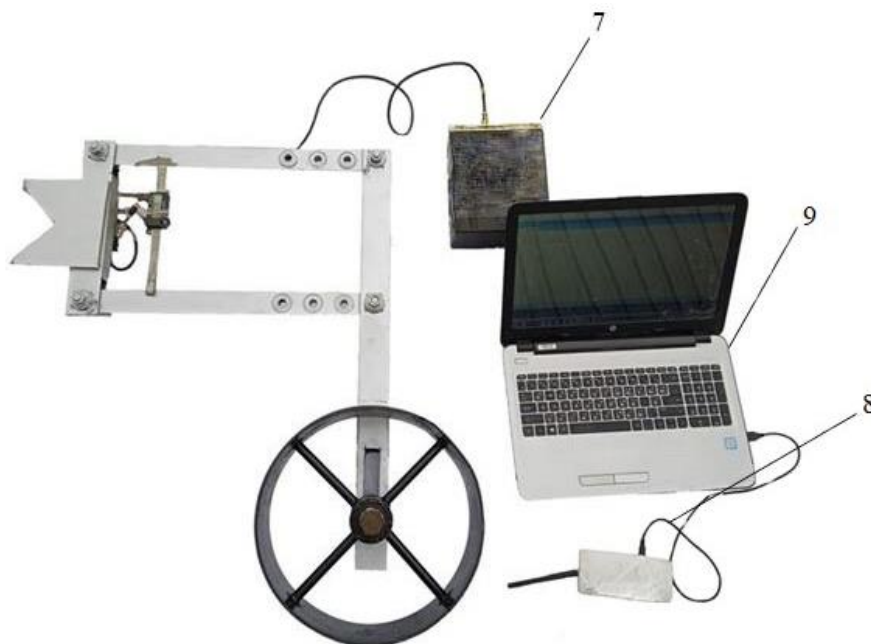
2-расм. Қурилманинг маълумотларни узатиш, уларни қабул қилиш ва қайд этиш қурилмалари билан биргалликдаги кўриниши
