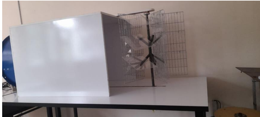
2-rasm. Vertikal o'qli shamolgeneratorini ochilib yopiluvchi qanotlarini ko'rinishi.
