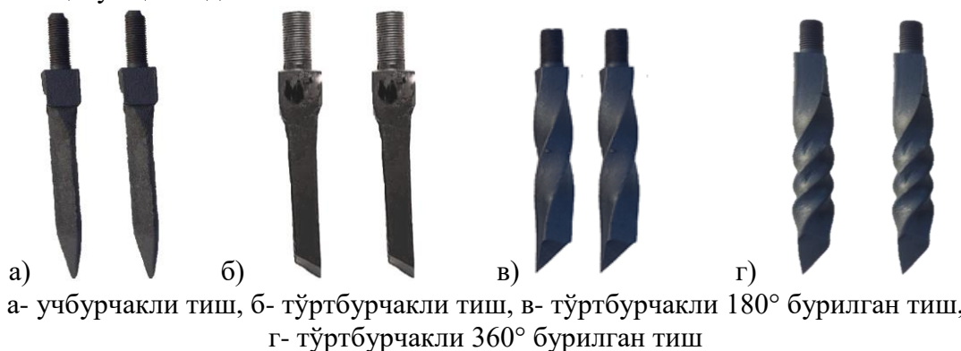
2-расм. Ротацион борона планкага ўрнатиладиган турли хил шаклдаги тишлар
