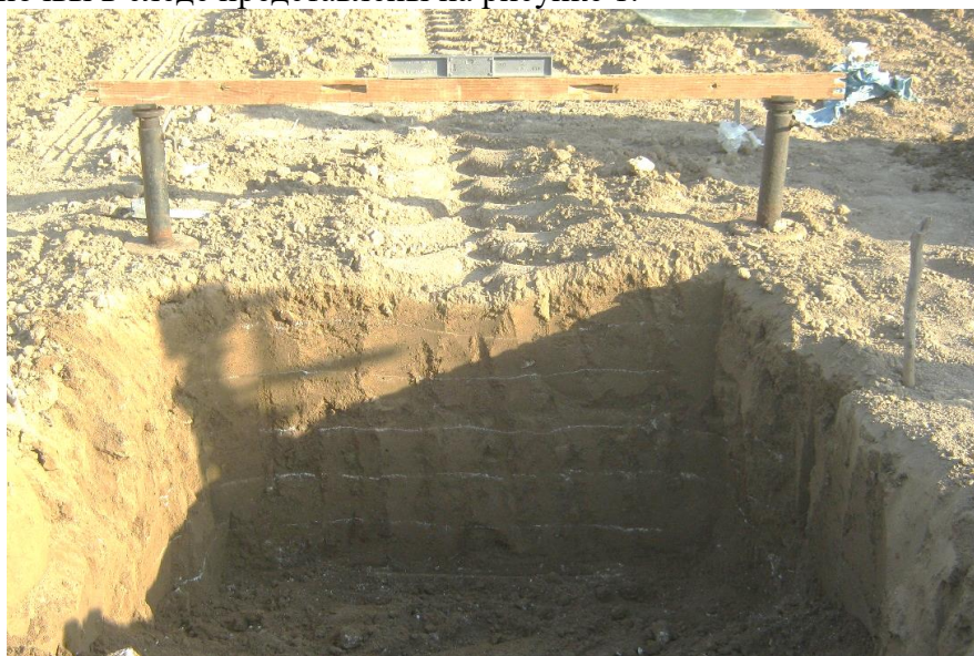
Рис.1. Профиль деформации слоя почвы в следе шины
