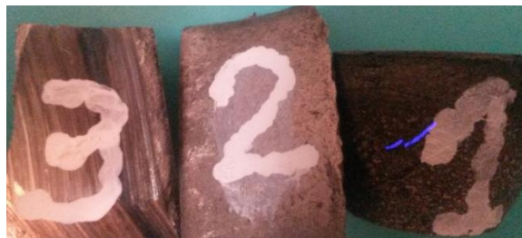
1- 280X29НЛ, 2 – 300X32Н2М2ТЛ, 3 – 330X17Л Рисунок 3. Образцов белых износостойких чугунов.
