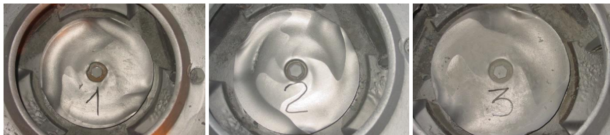
Рисунок 5. Внешний вид после эксплуатации питающей диск
