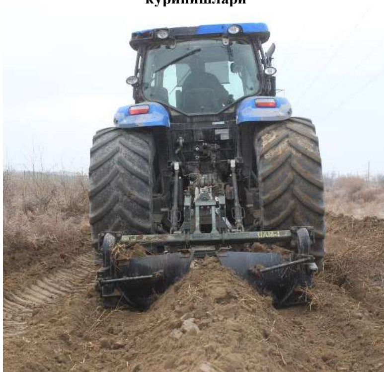
2-расм. Анор тупларини кўмадиган машинанинг иш жараёнидаги кўриниши
