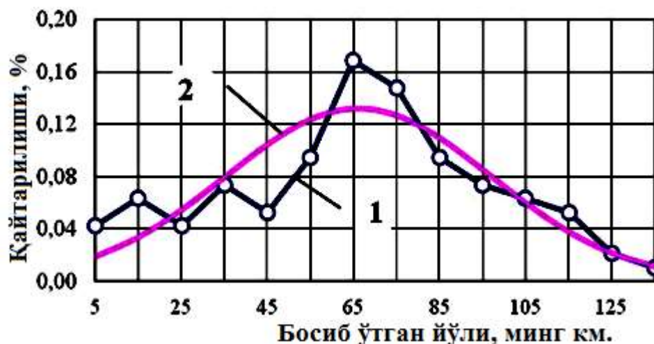
1-расм. ВАЗ русумли автомобилларнинг "Самара" оиласининг орқа амортизаторларининг бузилишига ишлаш вақтини тақсимланиши. 1 ва 2 - ҳақиқий ва ҳисобий тақсимот
