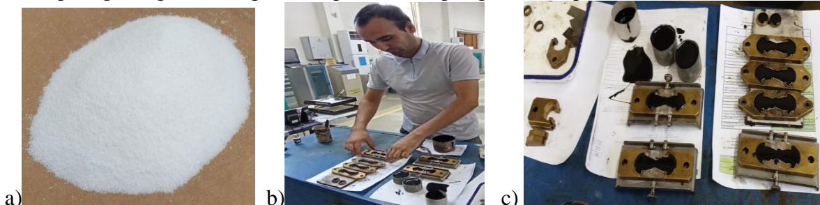
5-rasm. a) bitum tarkibini boyitish uchun qo'llanilgan plastifikator, b) tarkibi polimer bilan boyitilgan bitum namunlarini boratoriyada sinash uchun qoliplarga quyish jarayoni. c) laboratoriya sinovi uchun qoliplarga quyib tayyorlangan bitum namunalari
